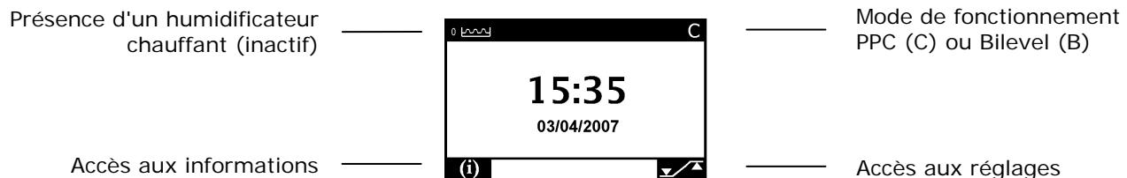
**Figure 2 – Vue de l'afficheur en mode veille**
