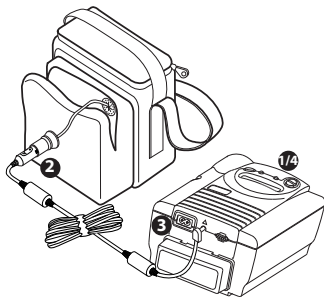
Obrázok 5: Pripojenie napájacieho kábla na jednosmerný prúd
